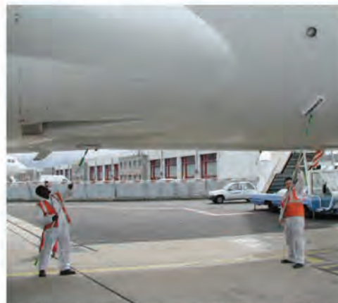
À la différence du nettoyage classique, le chiffonnage peut être fait à peu près n'importe où, ce qui permet d'autres opérations de maintenance en même temps.
