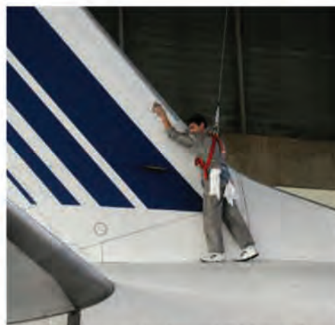
Aussi anachronique que cela puisse sembler, le lustrage d'un avion se fait à la main et à l'huile de coude !
