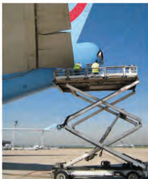
Le procédé de chiffonnage humide Ecoshine mis au point par UUDS permet d'économiser 99% de l'eau habituellement utilisée pour le nettoyage d'un avion, soit plusieurs milliers de litres.
